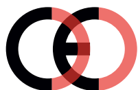
Falsk CE-mærke (for tæt på hinanden)
